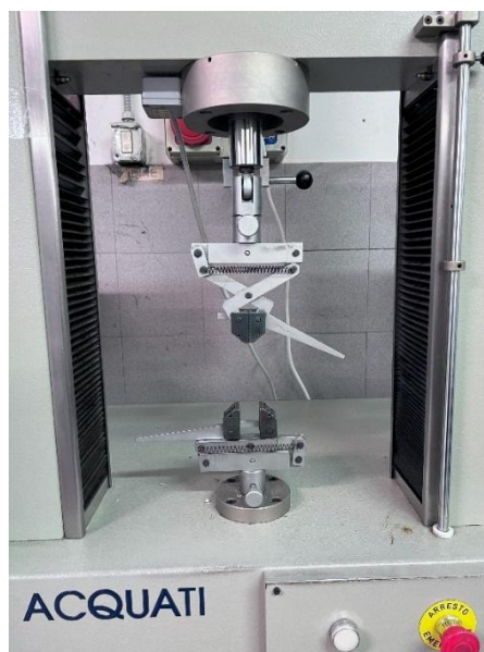
Fig. 3.1.13: Lo strumento che viene usato per effettuare la prova di trazione.
