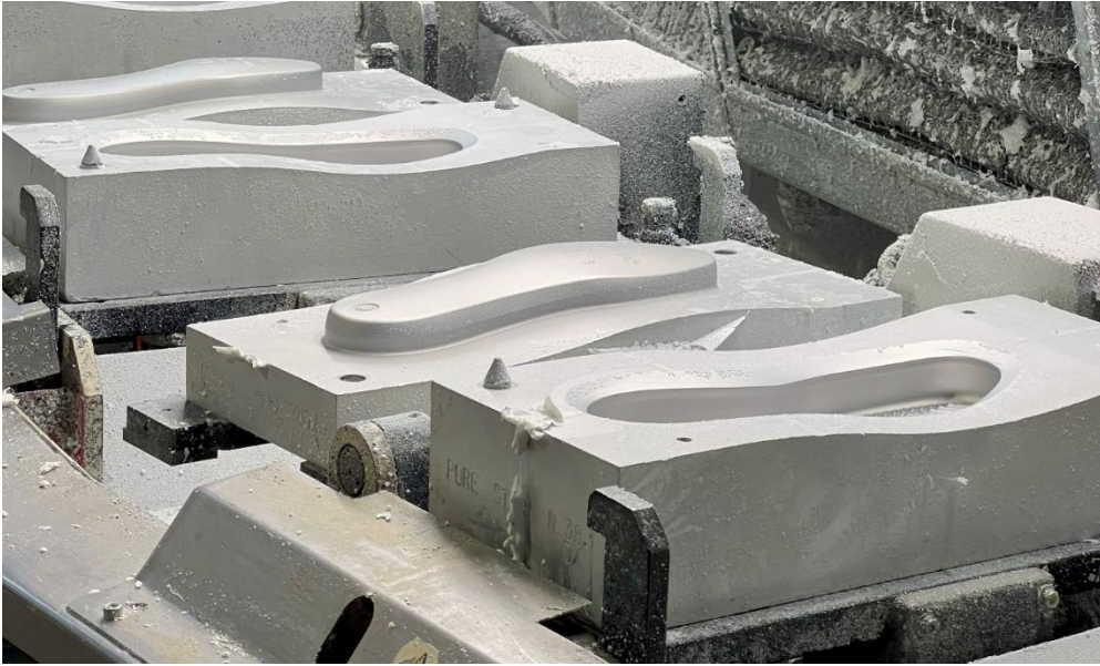
Fig. 3.2.15: Un altro tipo di stampi a colata che vengono montati su una giostra che vengono riempiti una volta passano sotto l'erogatore di materia prima
