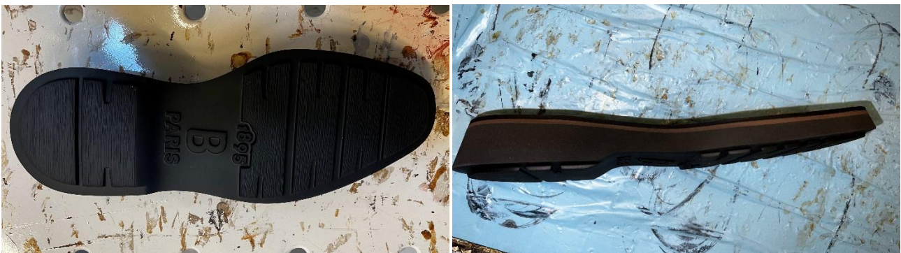
Fig. 2.1.7: Suola in EVA realizzata tramite la termoformatura.
