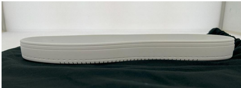
Fig. 2.1.4: Suola realizzata solo in TPU tramite lo stampaggio ad iniezione.
