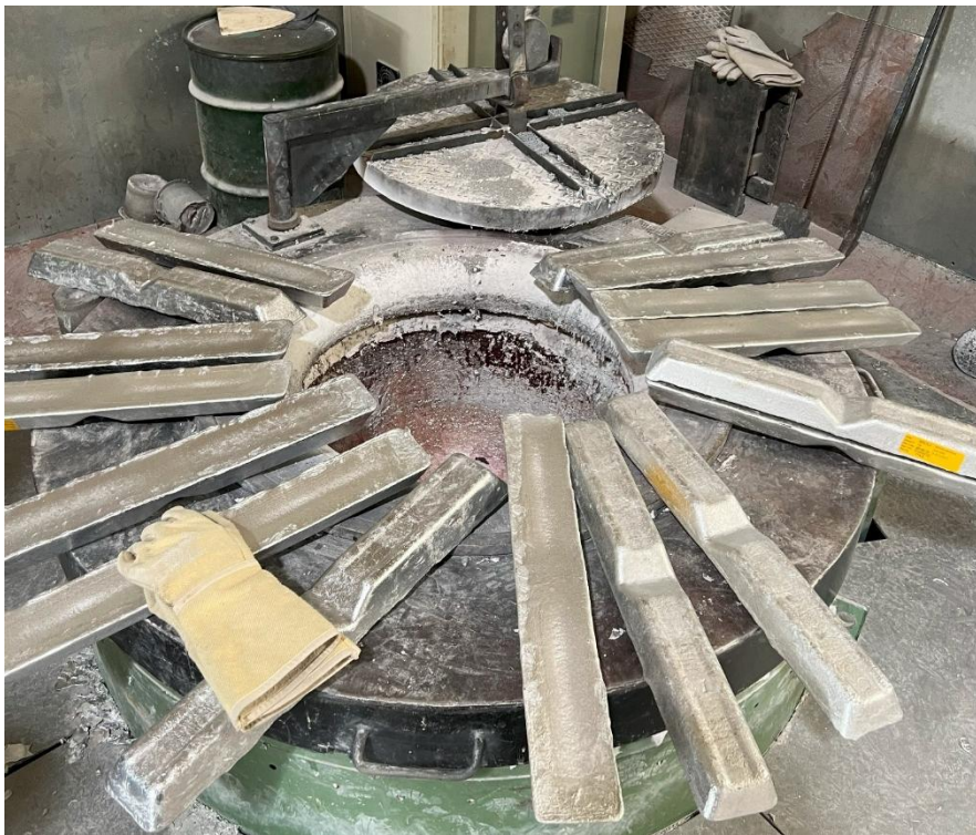
Fig. 3.1.9: Lingotti di alluminio che vengono fusi all'interno di un forno per la realizzazione dello stampo.
