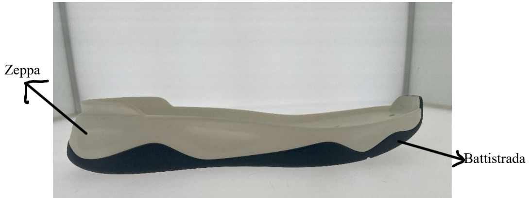
Fig. 2.1.3: Suola ibrida con battistrada in poliuretano termoplastico (TPU) stampato ad iniezione e la zeppa in poliuretano (PU) stampaggio a colata con film di rivestimento in PU.
