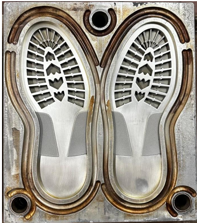
Fig. 3.1.8: La base stampo ad iniezione per battistrada.
