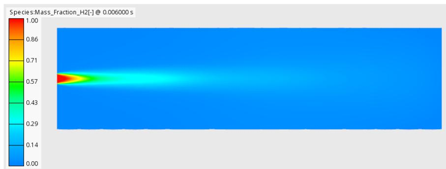
Figura 5.13: Mass fraction calcolata con il setup (b) all'istante  $t=0.006s$ , tenendo come boundary esterna una parete.
