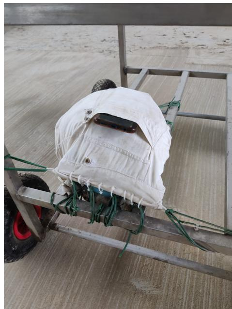
(b) Pantalone il stoffa, riempito con imbottitura per simulare il comportamento di una tasca di pantalone
