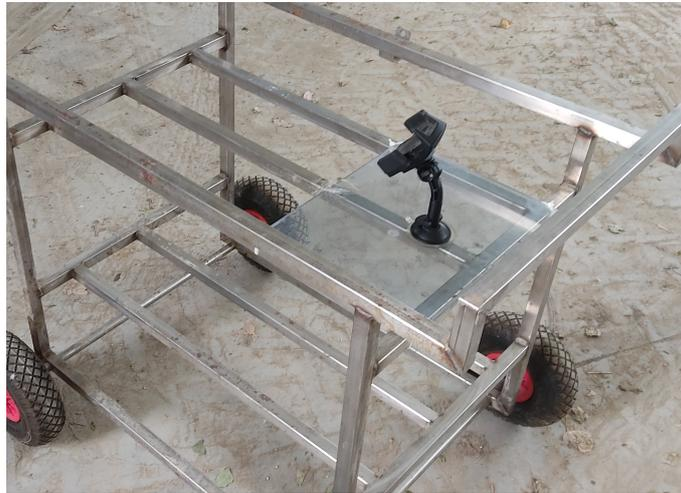
Figura 3.2: Supporto per telefono con ventosa montato sul carrello
