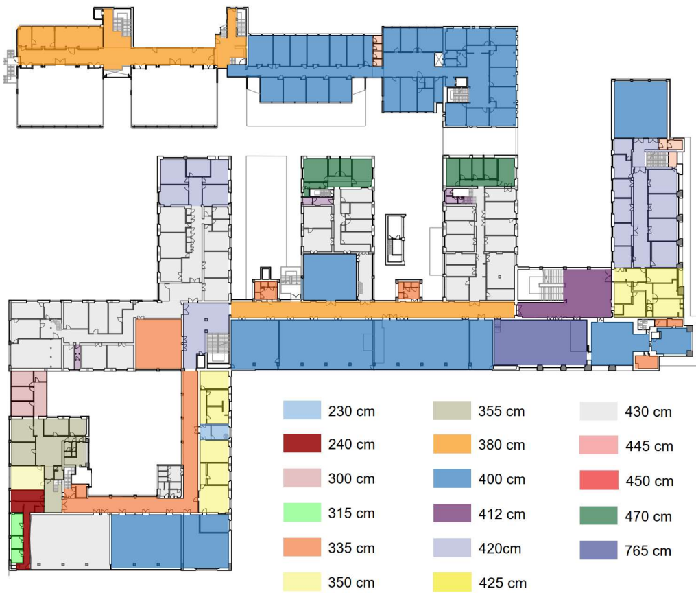
Figura 28 - Planimetria con altezze nette, piano primo (sopra) piano secondo (sotto)
