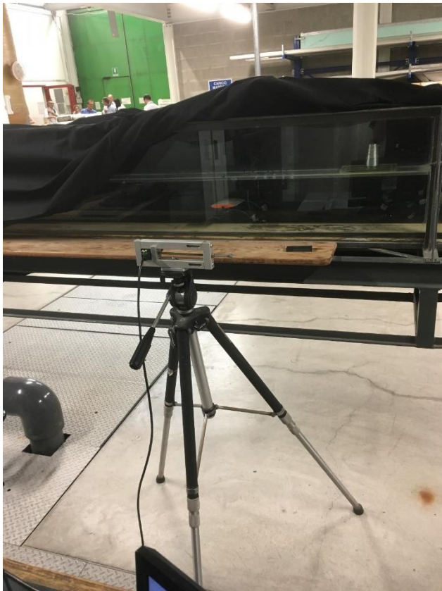
Figura 2.4. Inquadratura della regione della scia con videocamera
