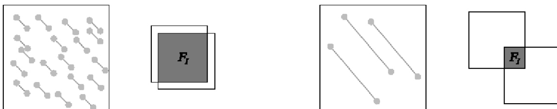
Figura 1.24. Riduzione del numero di coppie di particelle che rimangono all'interno dell'area di interrogazione, a seguito di elevati spostamenti (Dabiri, 2007)
