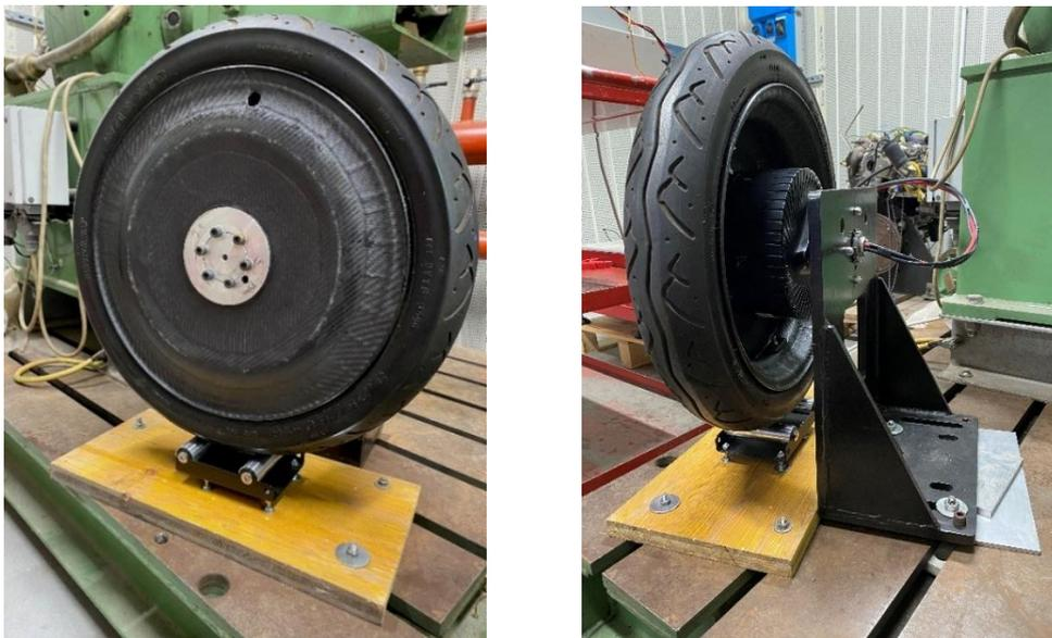
Figura 45. Montaggio motore e ruota al supporto.
