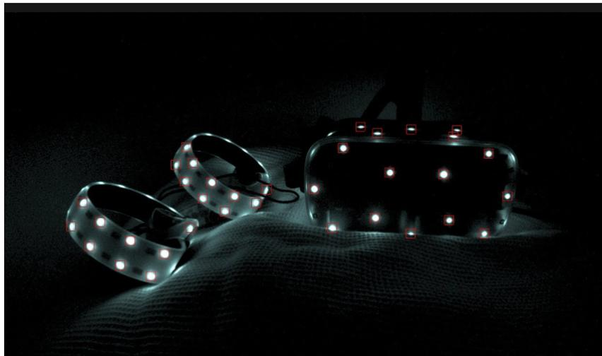
Figure 2.15: Led posizionati sul visore e sui controllers del sistema di tracciamento del Oculus Rift, raffigurazione di Mechatech (n.d.)
