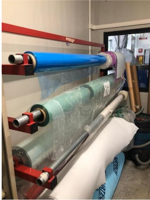
Figura 5.3: dall'alto: film separatore in azzurro, materiale per il sacco a vuoto in verde, breather material in bianco. Dietro: secondo materiale per sacco a vuoto rosa.
