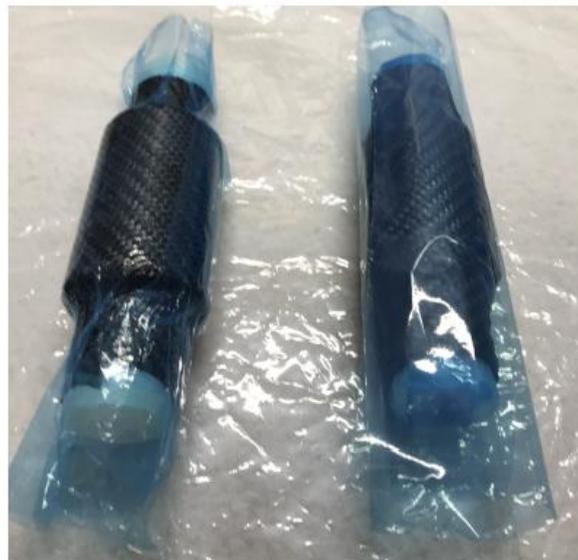
Figura 5.5: primo e secondo strato di film separatore.
