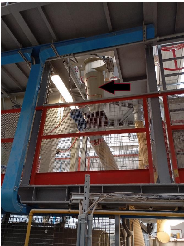
Figura 5 camera inferiore e superiore del separatore dinamico, impianto pilota Microton laboratorio LB Technology
