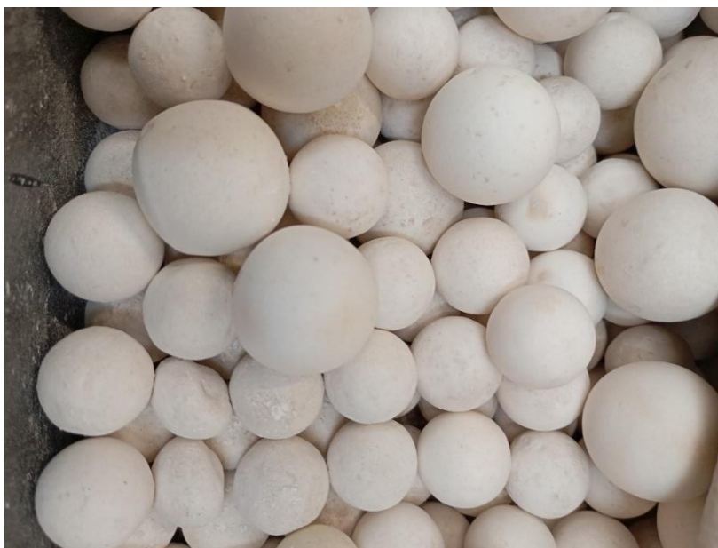
Figura 4 biglie di allumina utilizzate nel mulino MCS
