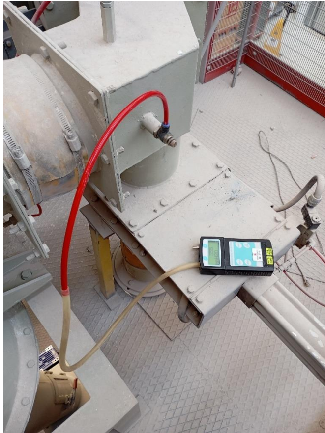
Figura 9 misurazione della pressione relativa in entrata e uscita dal separatore, impianto pilota laboratorio LB technology
