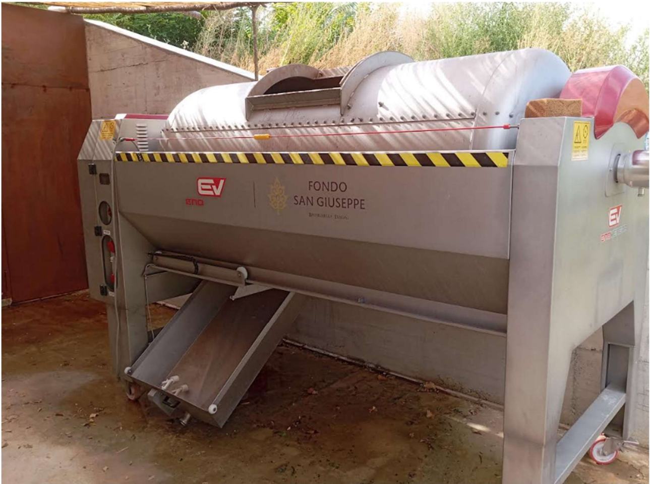
Fig. 8 Pressa pneumatica orizzontale PPC 18, capienza massima 18 Hl.
