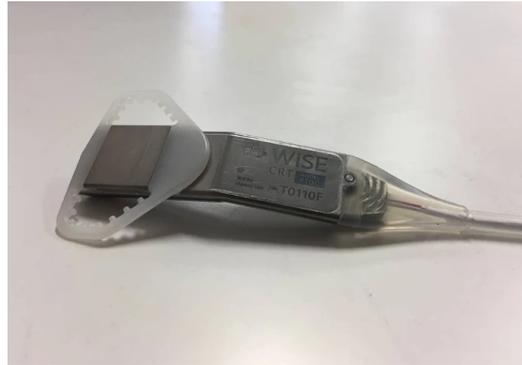
Figura 3.2: *Trasmettitore di ultrasuoni* [43]
