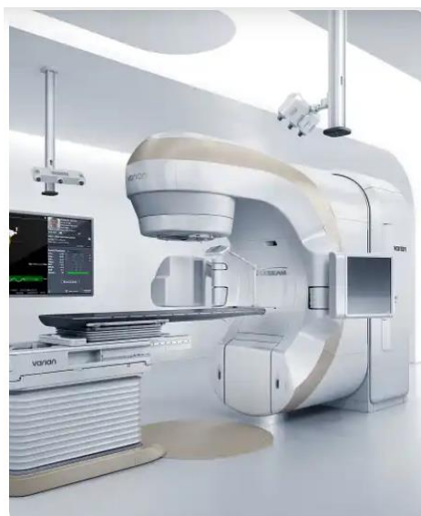
Figura 7: Sistema SGRT comprendente sensori Identify in un LINAC Varian
