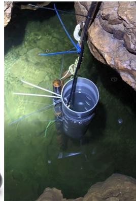
Figura 3.9 a dx - Ubicazione del trasduttore di pressione nel Lago Pensile.
