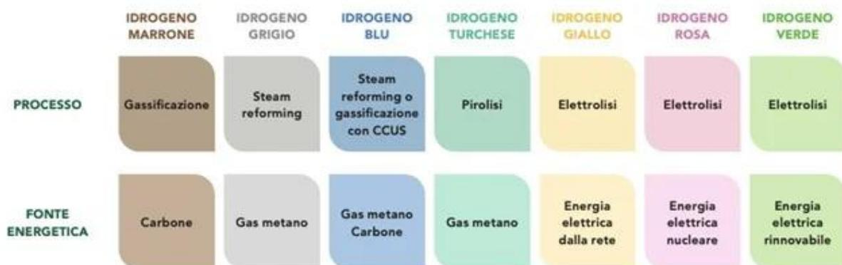
Figura 11: Schema colori dell'idrogeno
