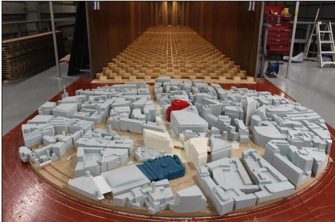
*figura 3.6 – Modello analisi in galleria del vento in scala 1:300 – vista Nord*
