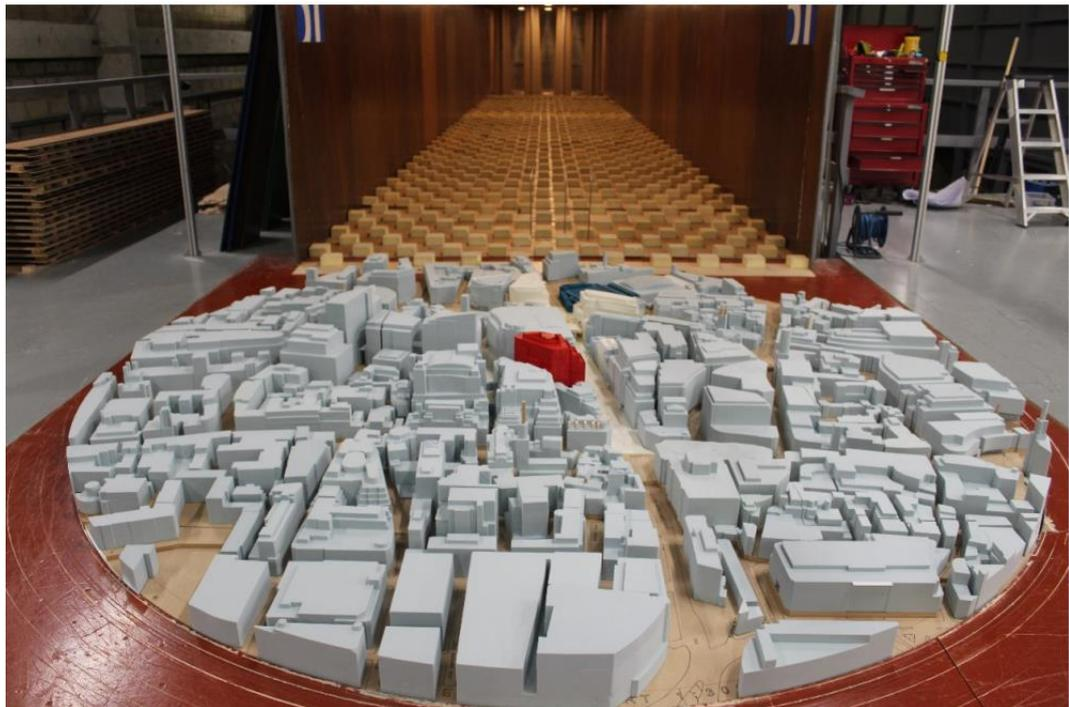
*figura 3.8 – Modello analisi in galleria del vento in scala 1:300 – vista Sud*
