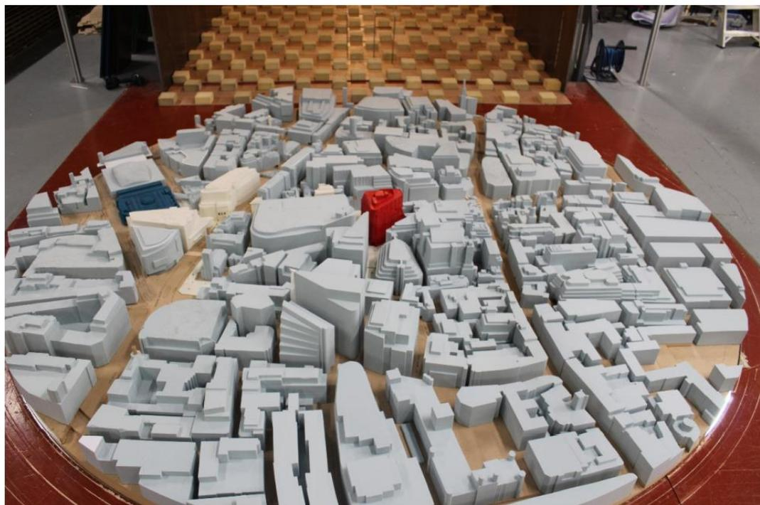
*figura 3.9 – Modello analisi in galleria del vento in scala 1:300 – vista Ovest*
