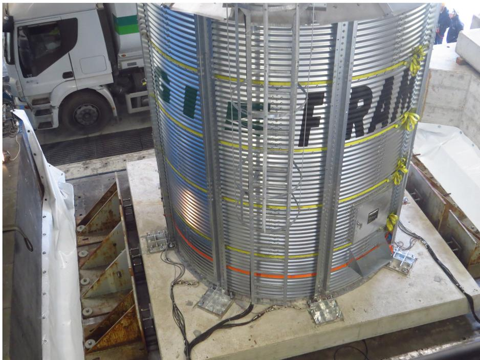
**Figura 22:** Particolare bloccaggio platea in calcestruzzo
