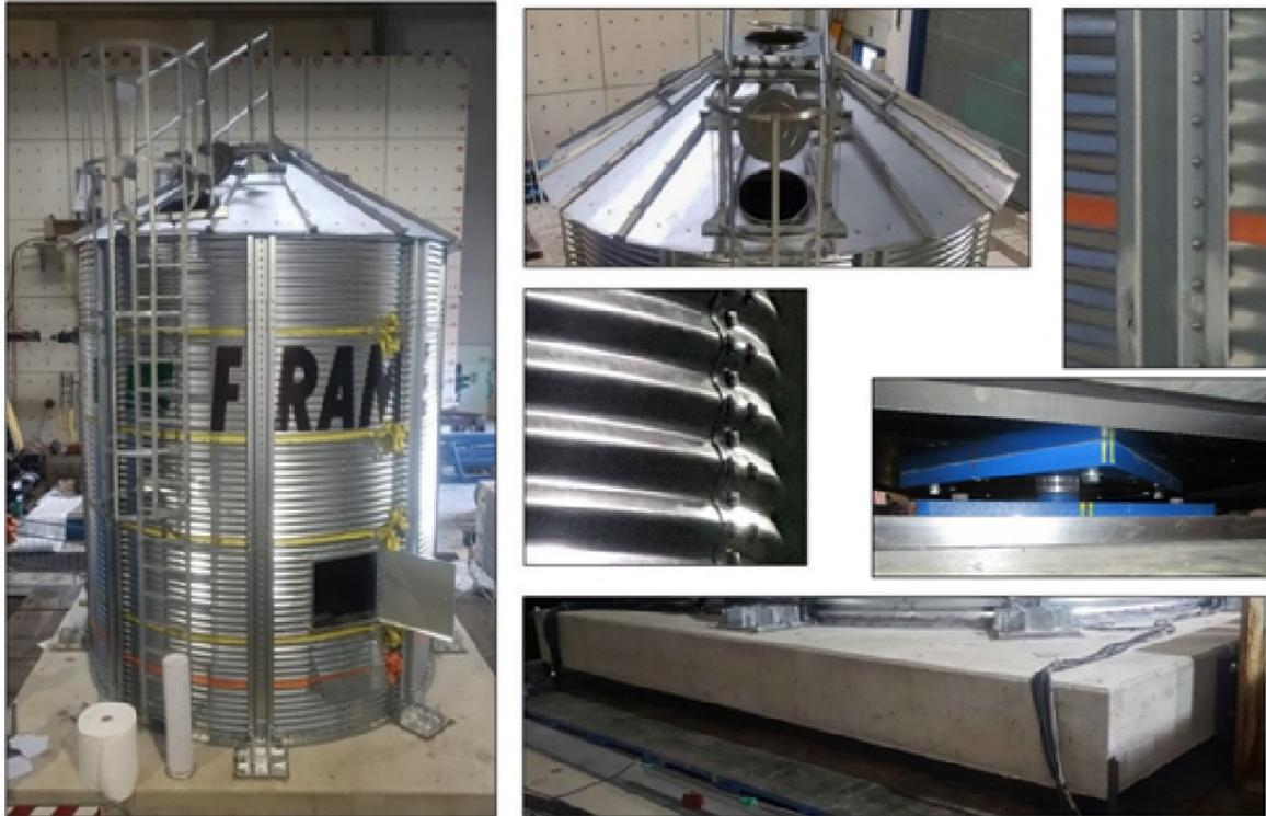
**Figura 6:** Silo testato e relativi particolari strutturali: silo (sinistra), tetto (in alto al centro), montante (in alto a destra), virola corrugata (al centro), isolatore (a destra al centro), platea di fondazione (in basso a destra).
