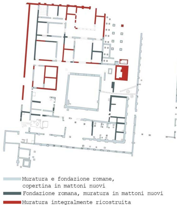
Fig. 59. Analisi delle murature esistenti, planimetria.
