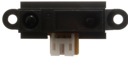
Figura A.12: Sensore di prossimità
