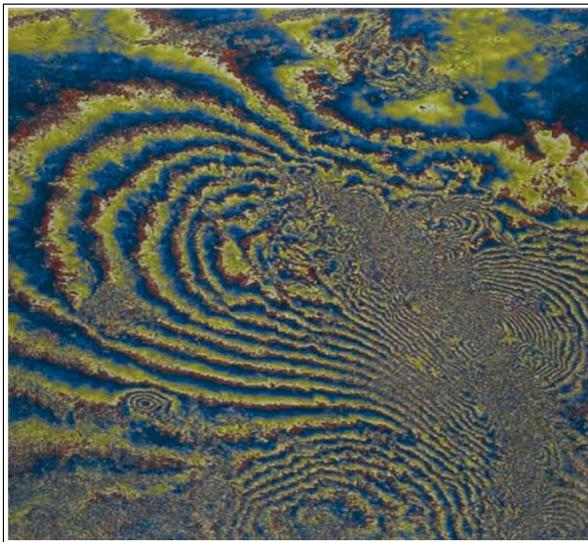
**Figura 30:** Interferogramma differenziale rappresentante i movimenti superficiali causati dal terremoto Landers (California, USA) avvenuto il 18 Giugno 1992. L'interferogramma è stato ricavato da due immagini ERS-1, la prima acquisita pre-evento il 24 Aprile 1992, la seconda post-evento il 7 Agosto 1992. (Fonte [20])
