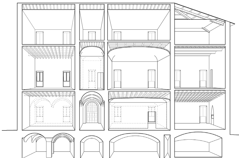
Disegno 07. Sezione prospettica su via Comandini con la ricostruzione degli spazi dopo i lavori di ristrutturazione di primo ottocento.
