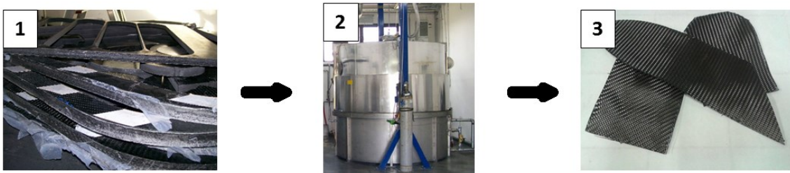
Figura 28. Recupero delle fibre di carbonio: 1) scarti e sfridi di lavorazione di CFRCs 2) Reattore dell'impianto di pirolisi CURTI S.p.A. 3) materiale in fibra di carbonio dopo pirolisi
