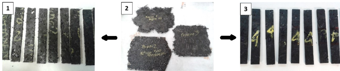
Figura 34. Preparazione dei provini per prove di trazione: 1) provini composito RC-500 2) lastre di compositi da cui sono stati ricavati i provini 3) provini RC600-P600-30
