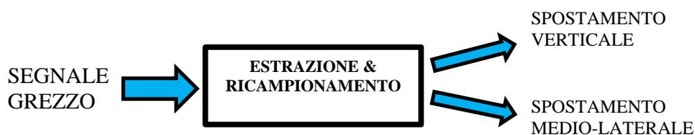
Nota: il vettore spostamento verticale è stato centrato in zero sottraendogli la media di tutti i valori e moltiplicato per un fattore correttivo che tenesse conto del piano inclinato del rilevatore rispetto al piano verticale (fig. 2.2):  $\text{corr}=\cos(38^\circ)$  .
