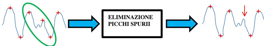
In questo modo il vettore dei picchi 'pks' contiene solo massimi e minimi alternati uno a uno. A questo è stato associato il vettore 'timepeaks' ed il vettore 'ind' che contengono i tempi di ogni picco e l'indice corrispondente nella matrice E.
