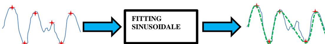
In ogni intorno dei picchi è stata disegnata una curva sinusoidale che seguisse al meglio l'andamento del segnale grezzo. Per far ciò, sono stati modellati i 4 parametri caratteristici
