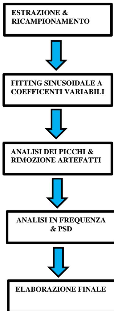
Nella prima fase di elaborazione, per ogni velocità di ogni soggetto, sono stati eliminati i primi 30 secondi e gli ultimi 30 secondi di registrazione. Al nuovo vettore dei tempi è stato sottratto il valore iniziale in modo da ottenere per tutti i tracciati  $v_0=0$  sec. Dalla matrice dei parametri sono stati poi estratti i due dati riguardanti lo spostamento del soggetto verticale e medio-laterale.
