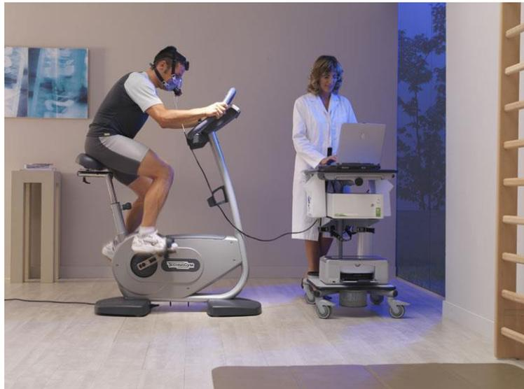
Fig. 1.11 Analisi del consumo energetico con metabografo[24]
