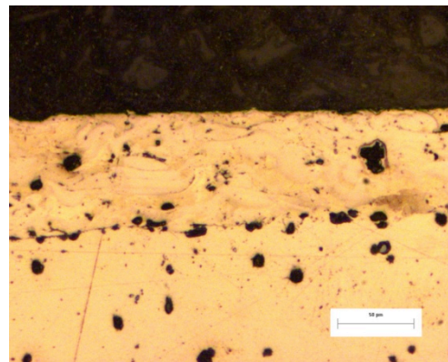
Figura 4.4. Immagini al microscopio ottico (a) Metco 442 PS; (b) Metco 445 PS (c) Amdry 1371 PS
