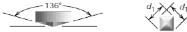
Figura A.6. Geometria dell'indentatore Vickers [37] .
