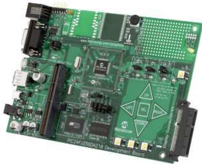
fig. 1.3: Scheda di sviluppo Development Board PIC24FJ256DA210 [2]
