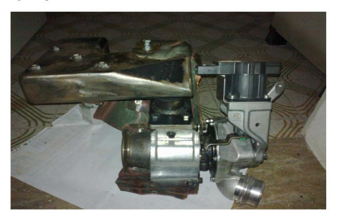
Figura 3: particolare collegato al gruppo della sovralimentazione con protezioni. Si nota lo "sbecco" eseguito per applicare il connettore alla turbina.
