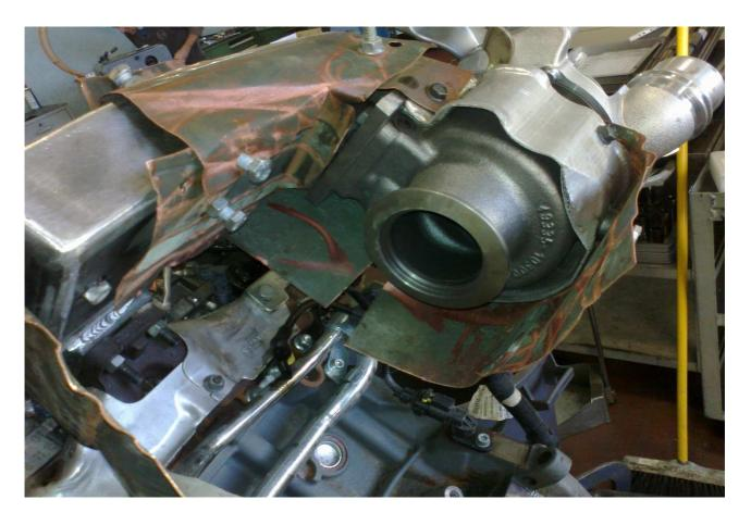
Figura 1: protezione gruppo turbocompressore.
