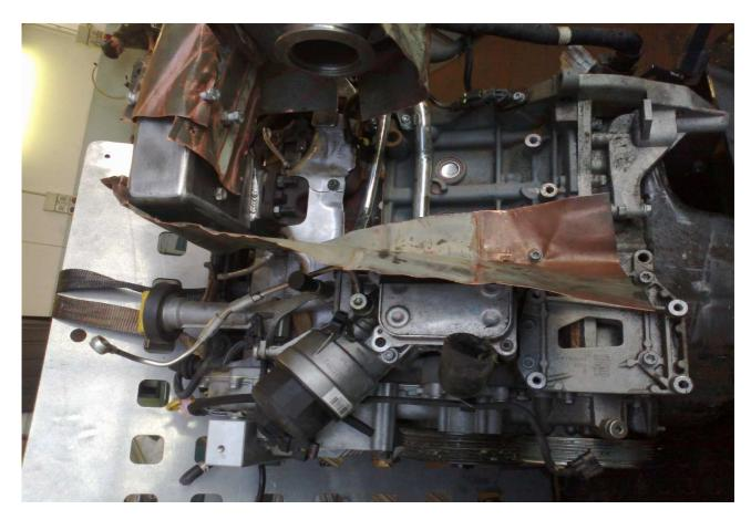
Figura 2: protezione zone limitrofe unità motrice.
