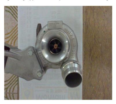
Figura 9: gruppo turbocompressore BMW; vista ingresso aspirazione e uscita compressore.
