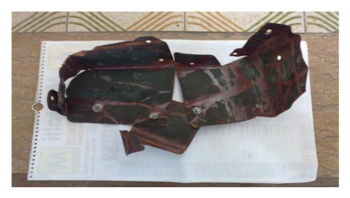
Figura 2: lamierini che proteggono il gruppo turbocompressore.
