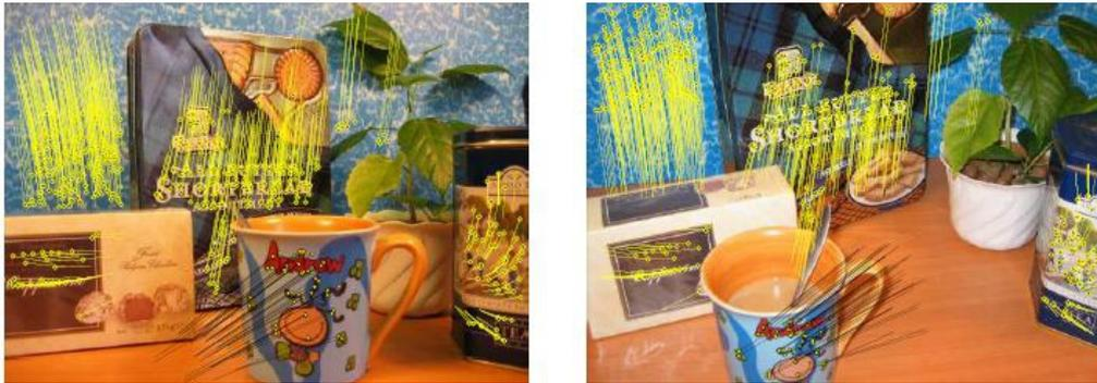
**Figura 46:** Immagine di riferimento per la valutazione del movimento. Viene visualizzato il movimento con dei segmenti: le linee chiare indicano il movimento del *background*, mentre le linee scure quello del *foreground* (il boccale) [45].
