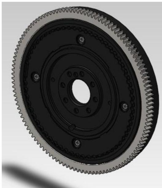
Fig. 4.20 – Volano originale con corona dentata e ruota fonica
