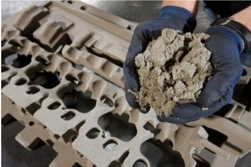
Fig. 3.5 – Anime in materiale refrattario
