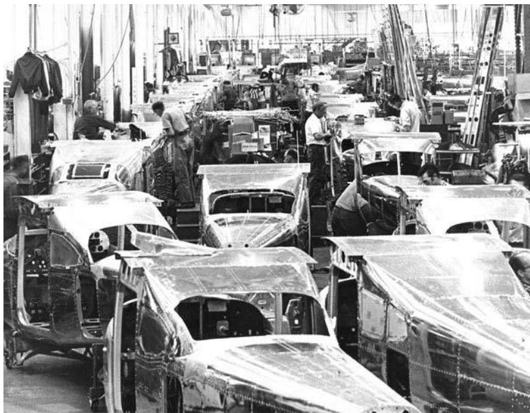
Fig. 1.1 – Catena di montaggio Cessna Aircraft Company
