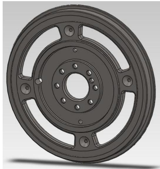
Fig. 4.22 – Volano alleggerito lato motore
