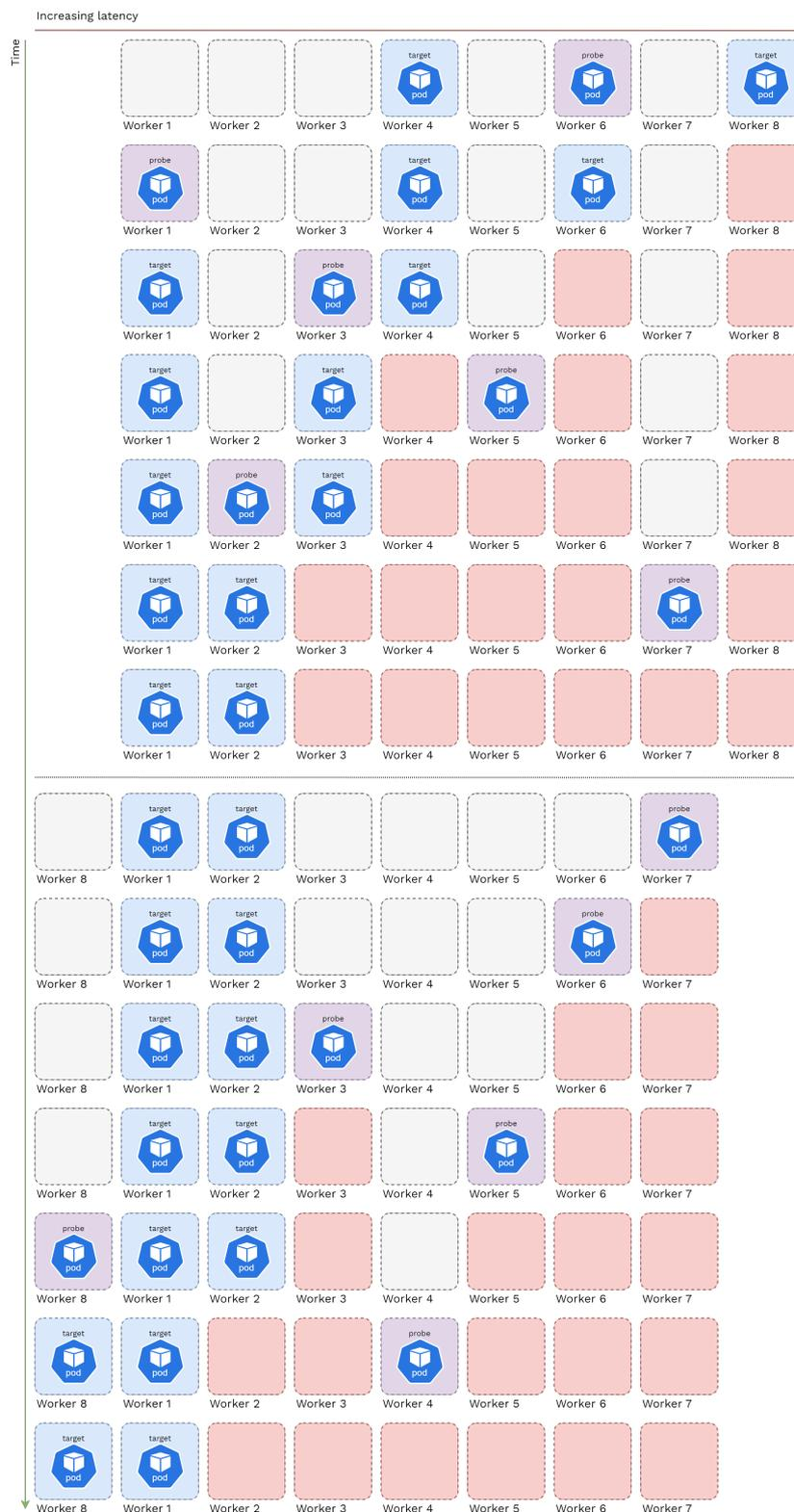
**Figura 5.4:** *Evoluzione temporale dello scheduling dei pod sui nodi worker del cluster durante tutte le fasi del terzo test*
