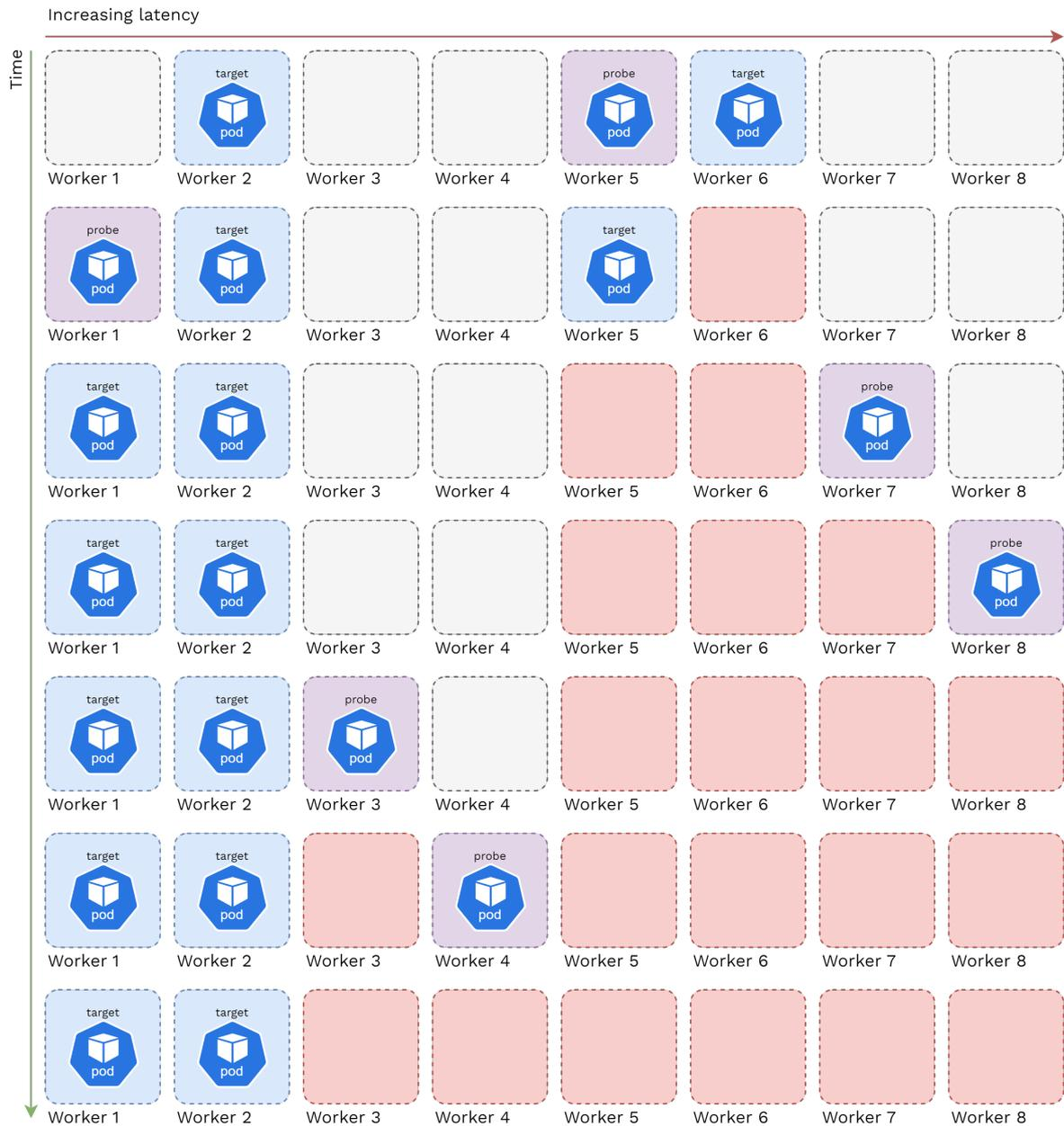
**Figura 5.3:** *Evoluzione temporale dello scheduling dei pod sui nodi worker del cluster durante il secondo test*
