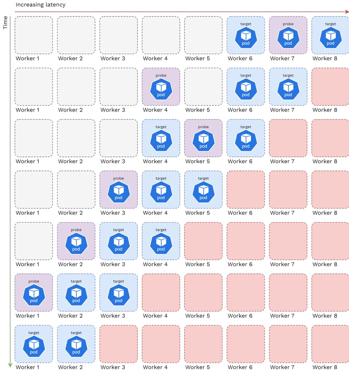
**Figura 5.2:** *Evoluzione temporale dello scheduling dei pod sui nodi worker del cluster durante il primo test*
