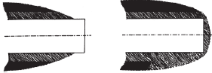
Figura 12: Possibili zone plastiche che possono svilupparsi nelle vicinanze del fronte ([20]).
