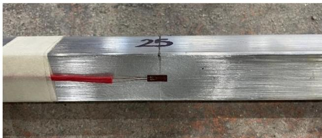
Figura 5.9: Montaggio estensimetro intradosso trave in prossimità incastro dx, nodo 25;
