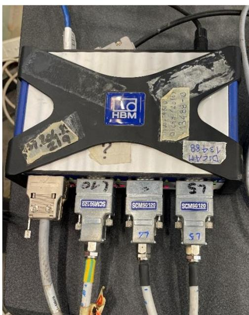
Figura 5.11: Collegamento estensimetri alla centralina IP 137.204.83.219;
