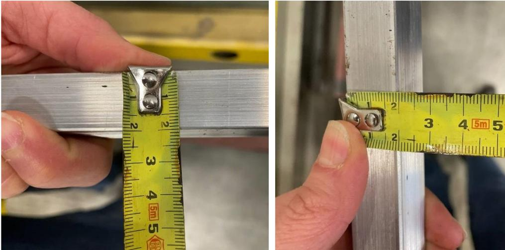
*Figura 1.26: Misura sezione con flessometro;*
