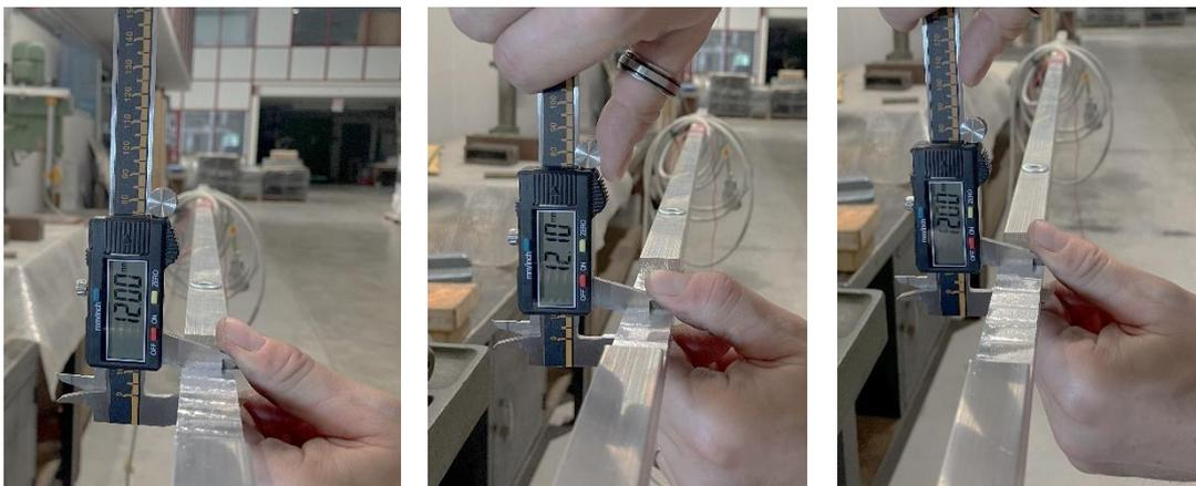
Figura 4.63: Misure altezza elemento 10 con calibro digitale dopo il quarto danneggiamento;
