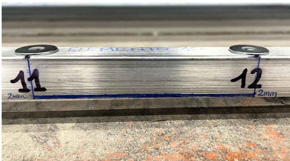
Figura 4.2: Identificazione porzione di 2 mm da rimuovere;
