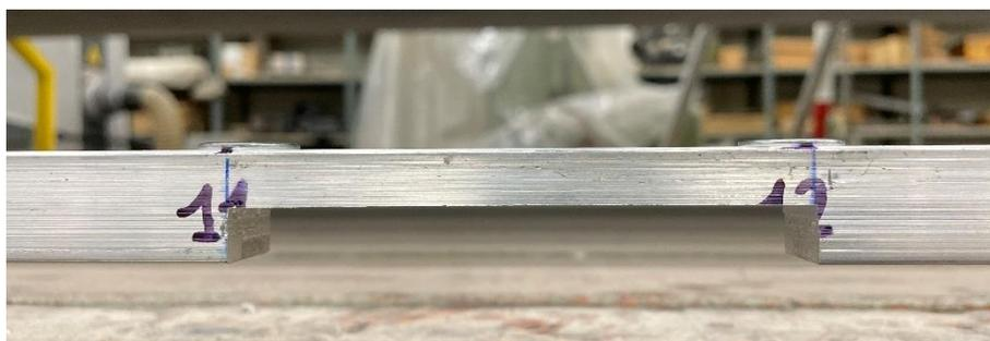
Figura 4.71: Realizzazione del quinto danno da  $2\text{ mm}$  sull'elemento 10;
