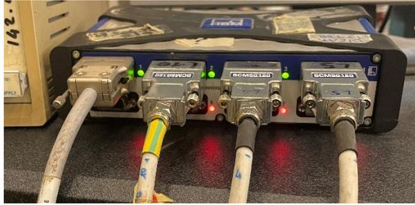
Figura 5.12: Collegamento ai canali 2-3-4 gli estensimetri nodo 3-14-25;
