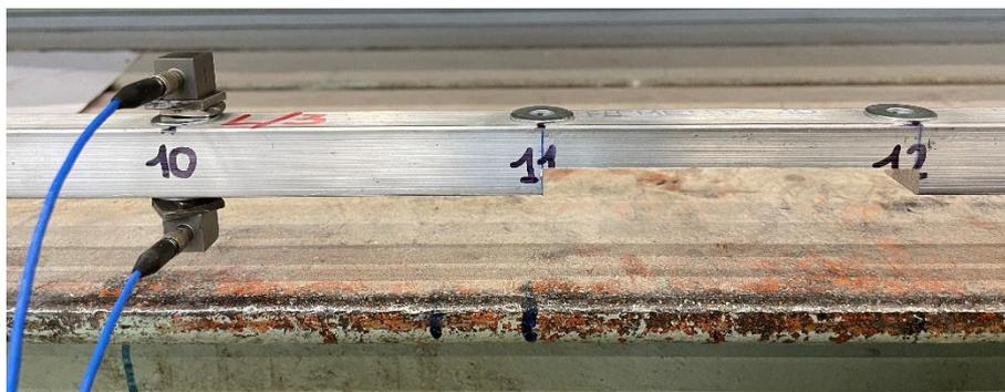
Figura 4.66: Tecnica Roving Sensor, accelerometro fisso nodo 10 e mobile nodo 10;
