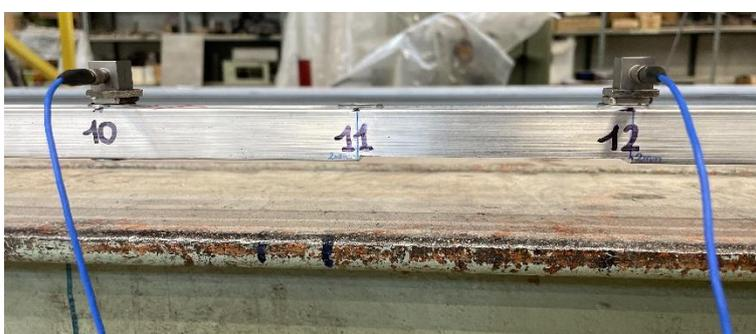
Figura 4.18: Tecnica Roving Sensor, accelerometro fisso nodo 10 e mobile nodo 12;
