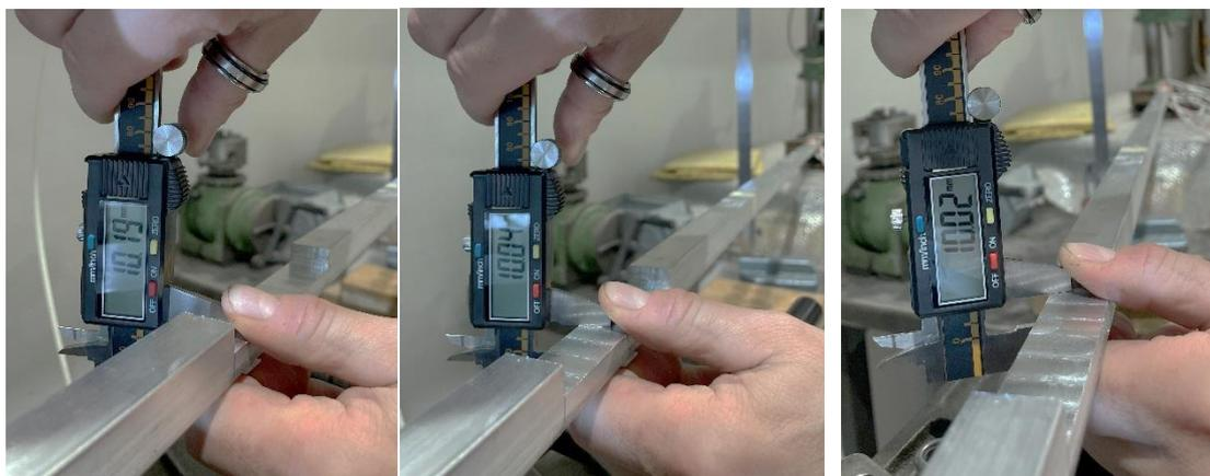
Figura 4.72: Misure altezza elemento 10 con calibro digitale dopo il quinto danneggiamento;
