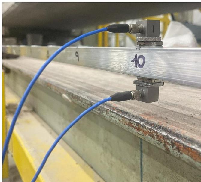
*Figura 3.48: Accelerometro 2 fisso e accelerometro 1 mobile nodo 10, tecnica Roving Sensor;*
