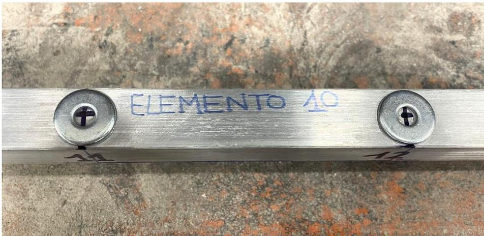
Figura 4.1: Identificazione elemento 10 da danneggiare, estradosso trave;
