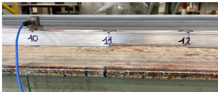
Figura 4.51: Tecnica Roving Sensor, terzo step di danno;
