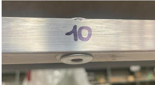
*Figura 3.46: Incollaggio rondella intradosso nodo 10, tecnica Roving Sensor;*
