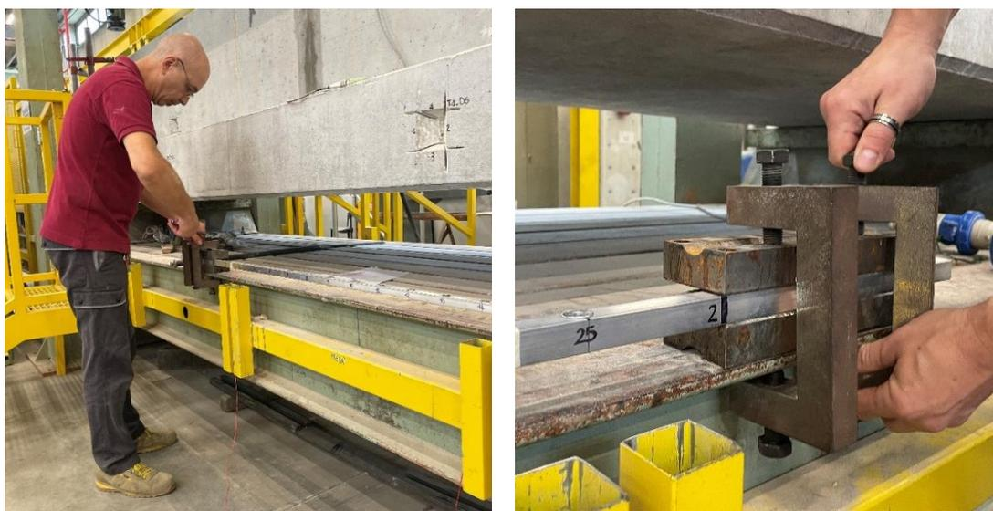
Figura 4.46: Smontaggio delle piastre che realizzano i vincoli;
