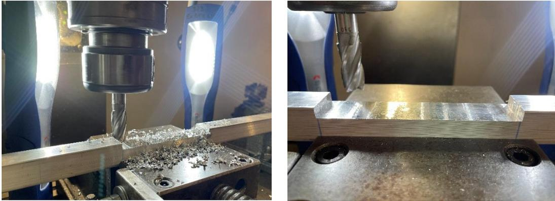
Figura 4.47: Esecuzione del terzo danno da 2 mm sull'elemento 10;
