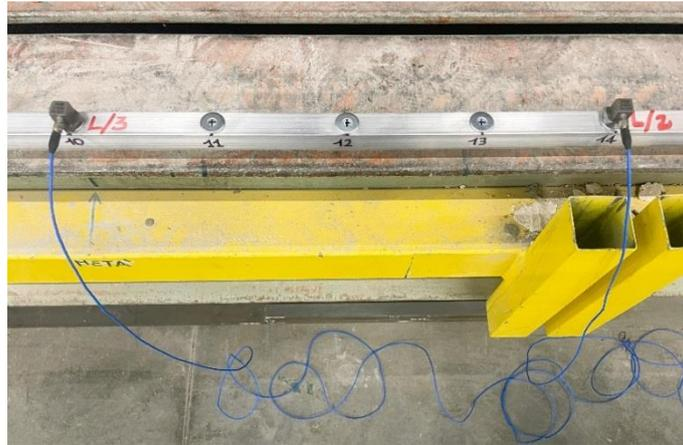
Figura 3.28: Posizione accelerometri tecnica Roving Hammer;
