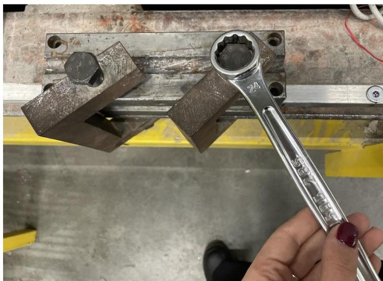
*Figura 4.6: Chiave inglese da 24 mm per rimozione bulloni ammorsati;*
