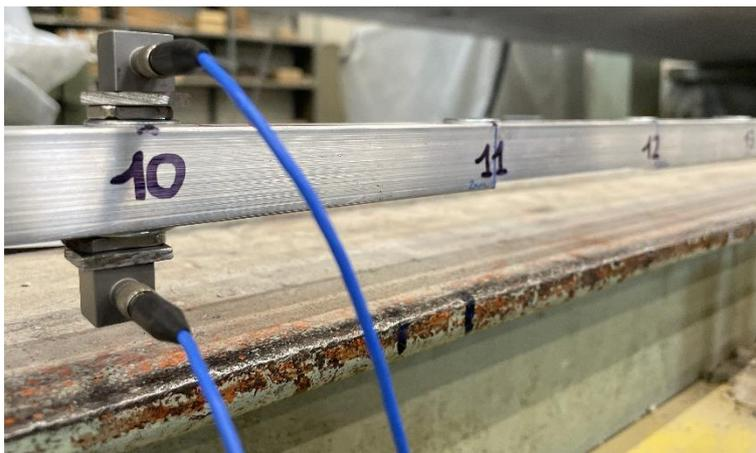
Figura 4.17: Tecnica Roving Sensor, trave danneggiata;
