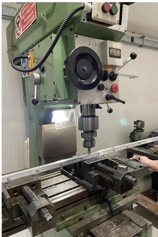
*Figura 4.26: Posizionamento trave nella fresatrice*
