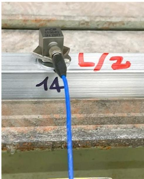
Figura 3.13: Collegamento Cavo-Accelerometro;
