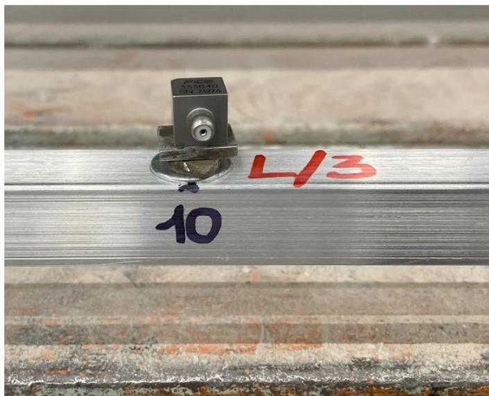
*Figura 3.9: Accelerometro 2 sul nodo 10 ad  $L/3$ ;*
