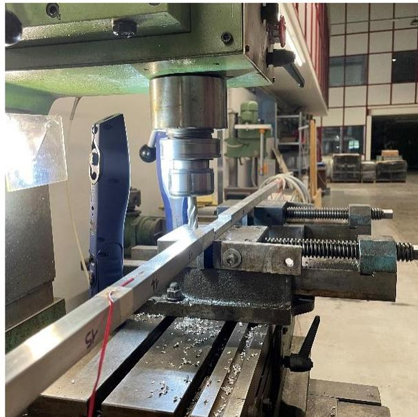
*Figura 4.60: Posizionamento trave nella fresatrice;*
