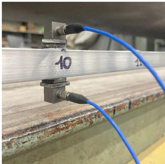
*Figura 3.47: Doppia strumentazione, accelerometro 1 mobile intradosso, tecnica Roving Sensor;*
