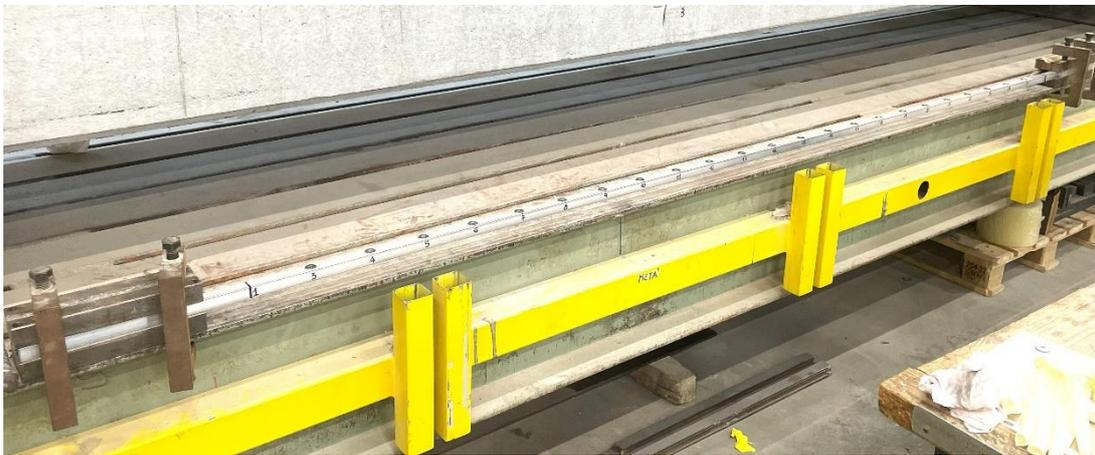
*Figura 3.7: Trave in alluminio posizionata per la prova dinamica;*
