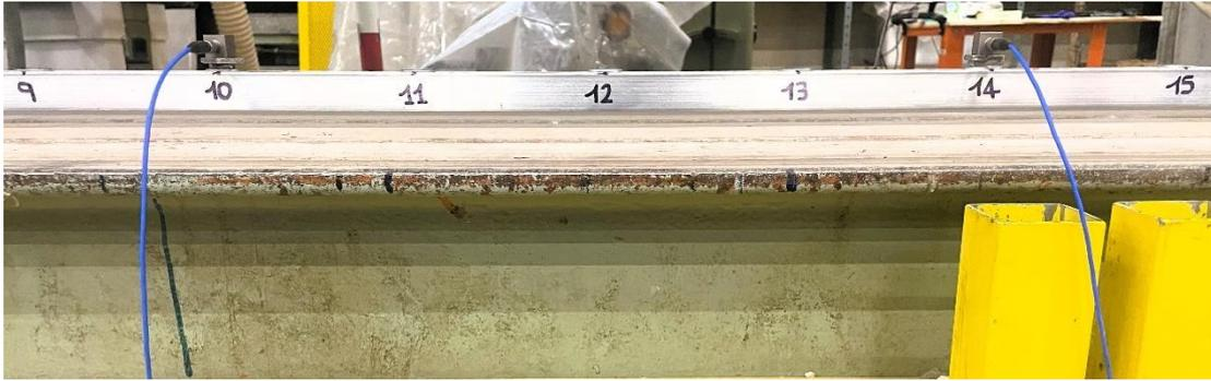
Figura 3.10: Posizionamento degli accelerometri;
