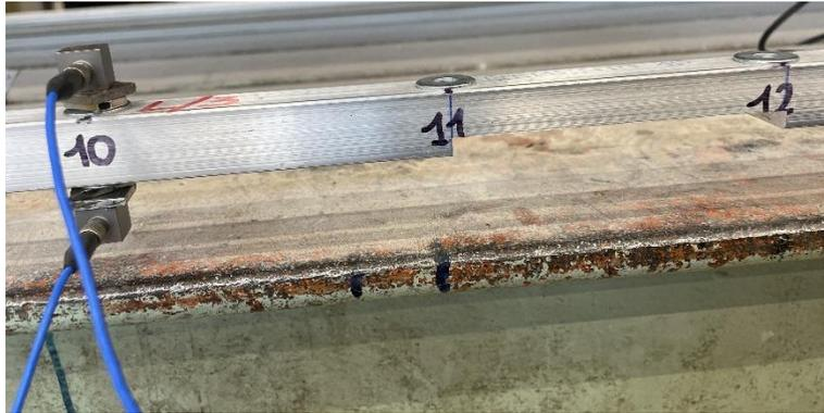
Figura 4.52: Tecnica Roving Sensor, accelerometro fisso nodo 10 e mobile nodo 10;
