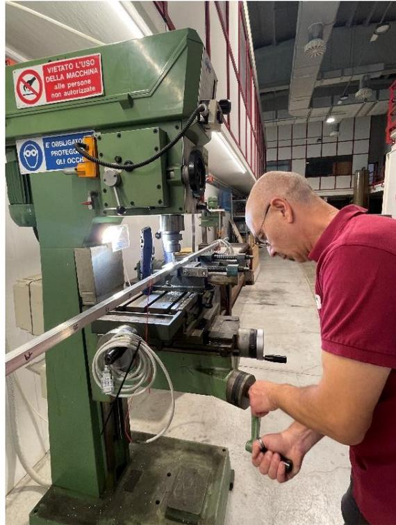
Figura 4.61: Esecuzione del quarto danno da 2 mm sull'elemento 10;
