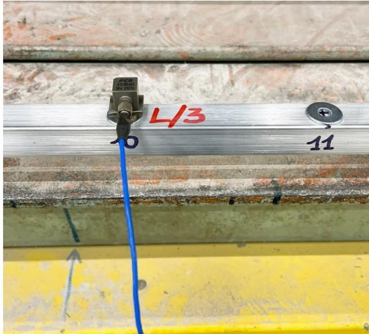
Figura 3.44: Posizione accelerometro 2 fissa sul nodo 10, tecnica Roving Sensor;
