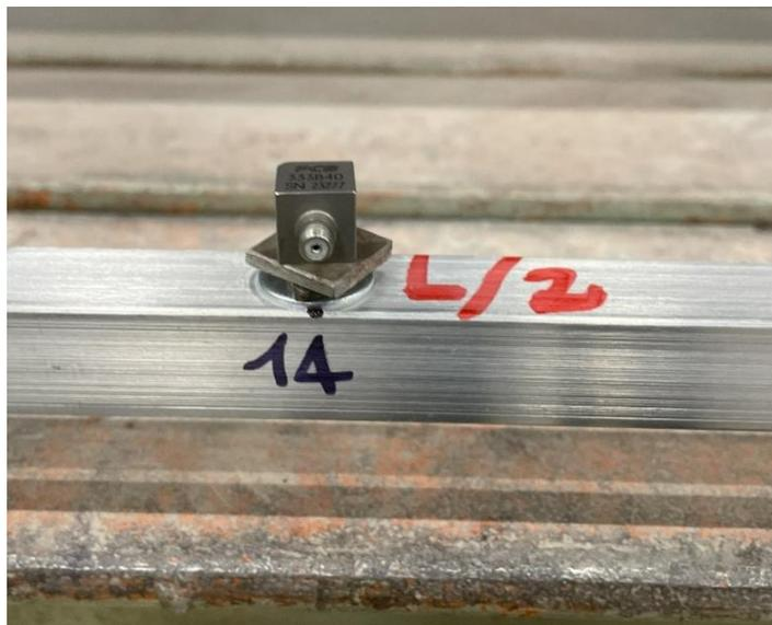
*Figura 3.8: Accelerometro 1 sul nodo 14 ad  $L/2$ ;*
