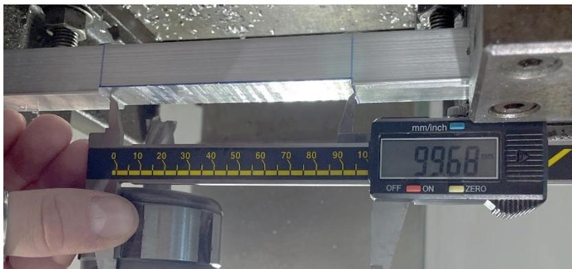
Figura 4.13: Misura lunghezza elemento 10 con calibro digitale;
