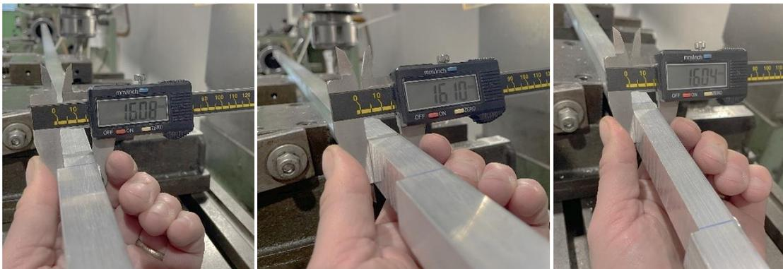
Figura 4.29: Misure altezza elemento 10 con calibro digitale dopo il secondo danneggiamento;
