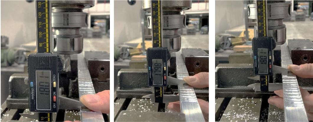
Figura 4.12: Misurazioni altezza elemento 10 con calibro digitale dopo il primo danneggiamento;
