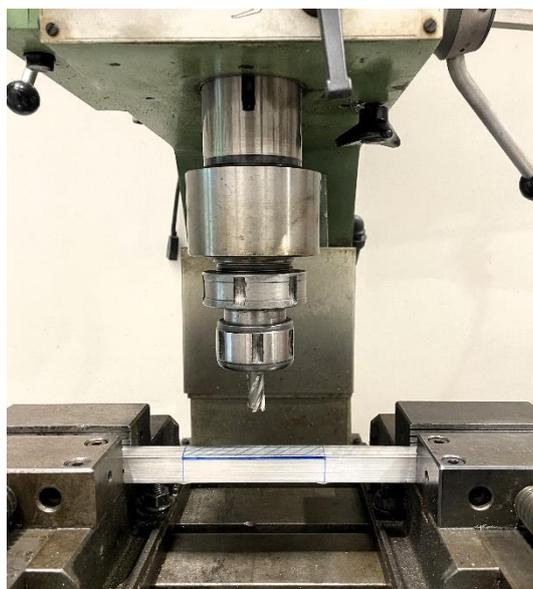
*Figura 4.9: Posizionamento elemento da danneggiare nella fresatrice*
