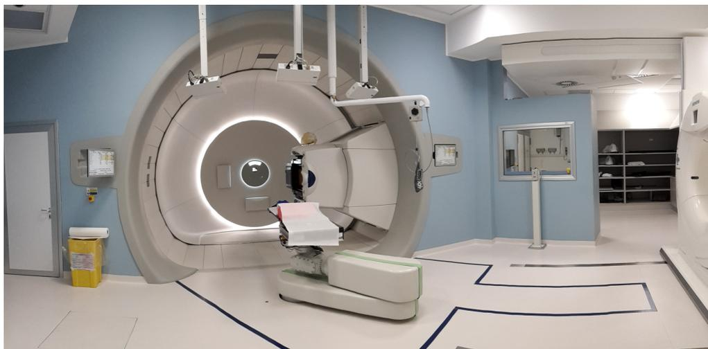
Figura 1.6: Sistema gantry “Blu” del Centro di Protonterapia di Trento [41].
