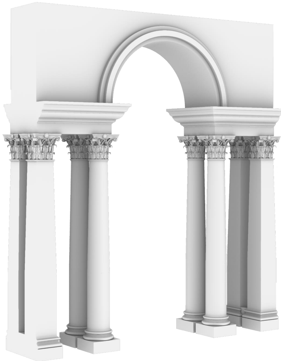
Figura 33 Ricostruzione 3D della serliana con riferimento alla Basilica Palladiana
