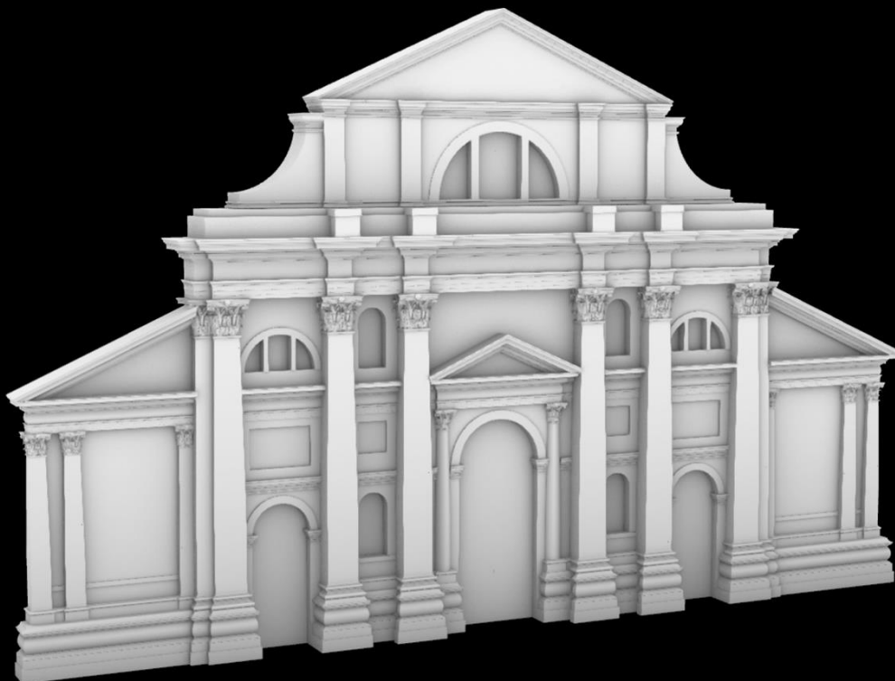
Versione con paraste in facciata: vista prospettica
