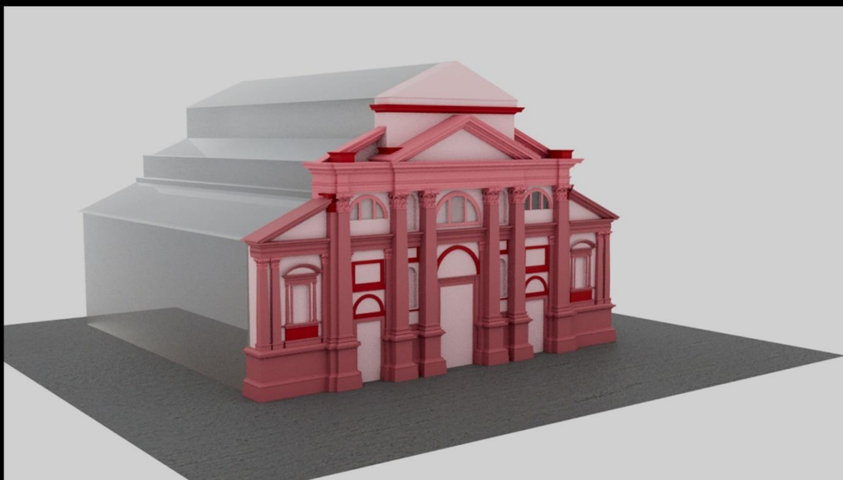
Modello tridimensionale della metà sinistra del disegno 63 che presenta un gradiente di colori per distinguere gli elementi certi da quelli incerti.
