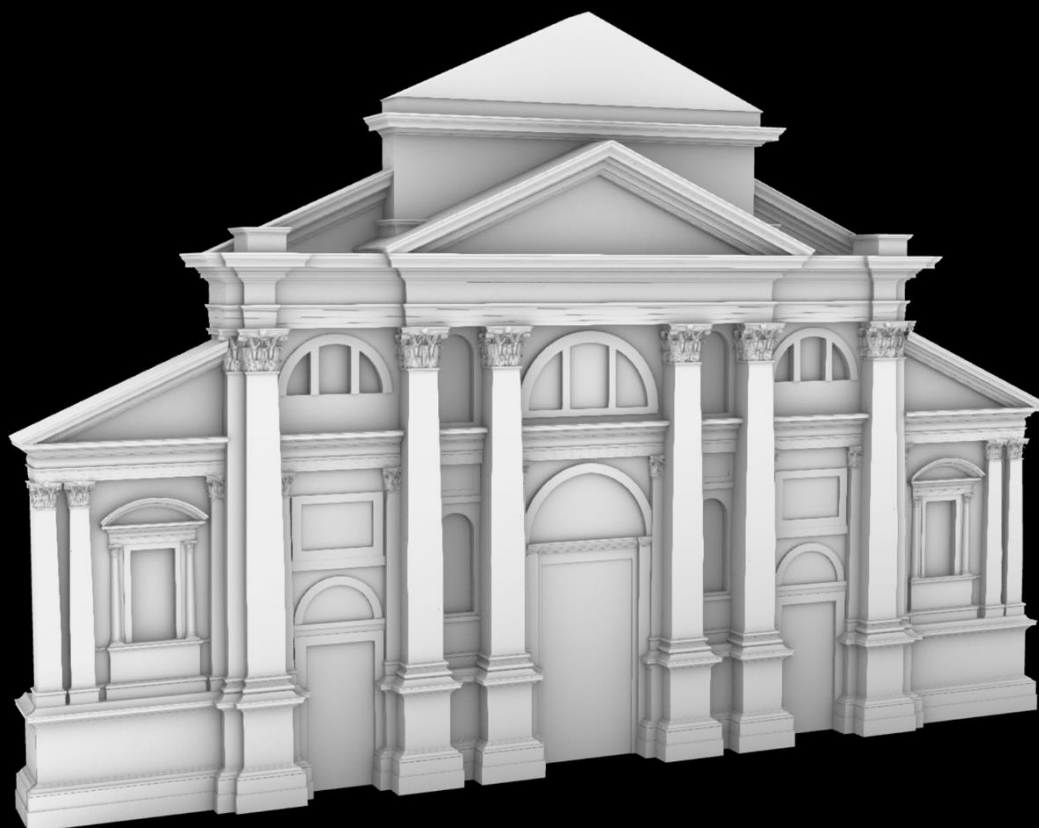
Versione con paraste in facciata: vista prospettica
