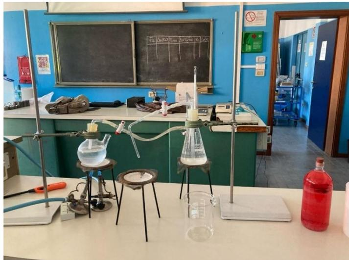
Figura 2.1: Strumenti e materiali utilizzati per la costruzione di una macchina di Savery in laboratorio.
