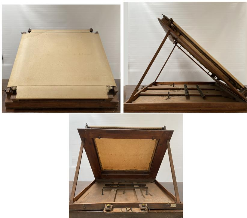
Figura 3.4: L'apparato di Righi come si presenta aperto da varie angolazioni. Sul fronte si vede bene la grande tela fissata al telaio tramite viti a dado in grado di regolarne la tensione, mentre sul retro si nota ciò che rimane del circuito che collegava la pila ai diapason e i supporti degli stessi.
