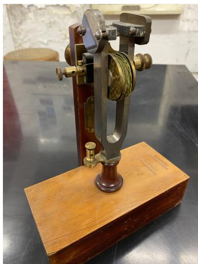
Figura 3.7: Diapason elettromagnetico prodotto da Max Kohl. A differenza di quello di Righi la posizione dei rebbi è verticale ma il funzionamento è del tutto simile trattandosi non necessitando del mercurio per chiudere il circuito.
