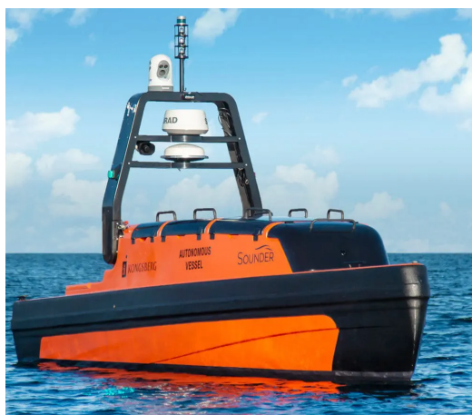
Figura 1.6: Sounder - Unmanned Surface Vehicle per studi idrografici
