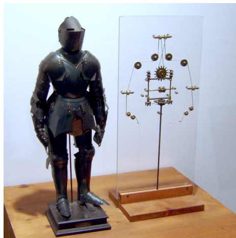
Figura 1.1: Modello dell'automa cavaliere di Leonardo e (a fianco) i suoi meccanismi interni (esposizione Leonardo da Vinci. Mensch - Erfinder - Genie, Berlino 2005)
