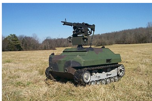
Figura 1.5: Il Gladiator Tactical Unmanned Ground Vehicle è progettato da Emil Lien Akre nel 2005 per supportare il Corpo dei Marines degli Stati Uniti nelle missioni Ship To Object Maneuver (STOM).
