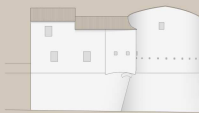
E - Torreione con abitazione (via de Gasperi) Complesso caratterizzato da un insieme di interventi volti alla realizzazione di locali a uso residenziale nati sul torreione e sulla cinta preesistente messi in atto tra la fine del XVII sec. e la metà del XIX sec.
