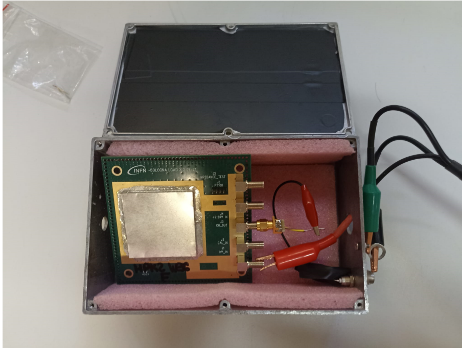
Figura 3.4: Setup per le misure IV. Il sensore è posizionato dentro la scatola che verrà chiusa e coperta per mantenere il sensore completamente al buio e schermato da un eventuale noise elettronico esterno durante la presa dati. La scheda è alimentata dall'esterno da un alimentatore di alta tensione e il connettore centrale è connesso al picoamperometro per le misure di corrente.
