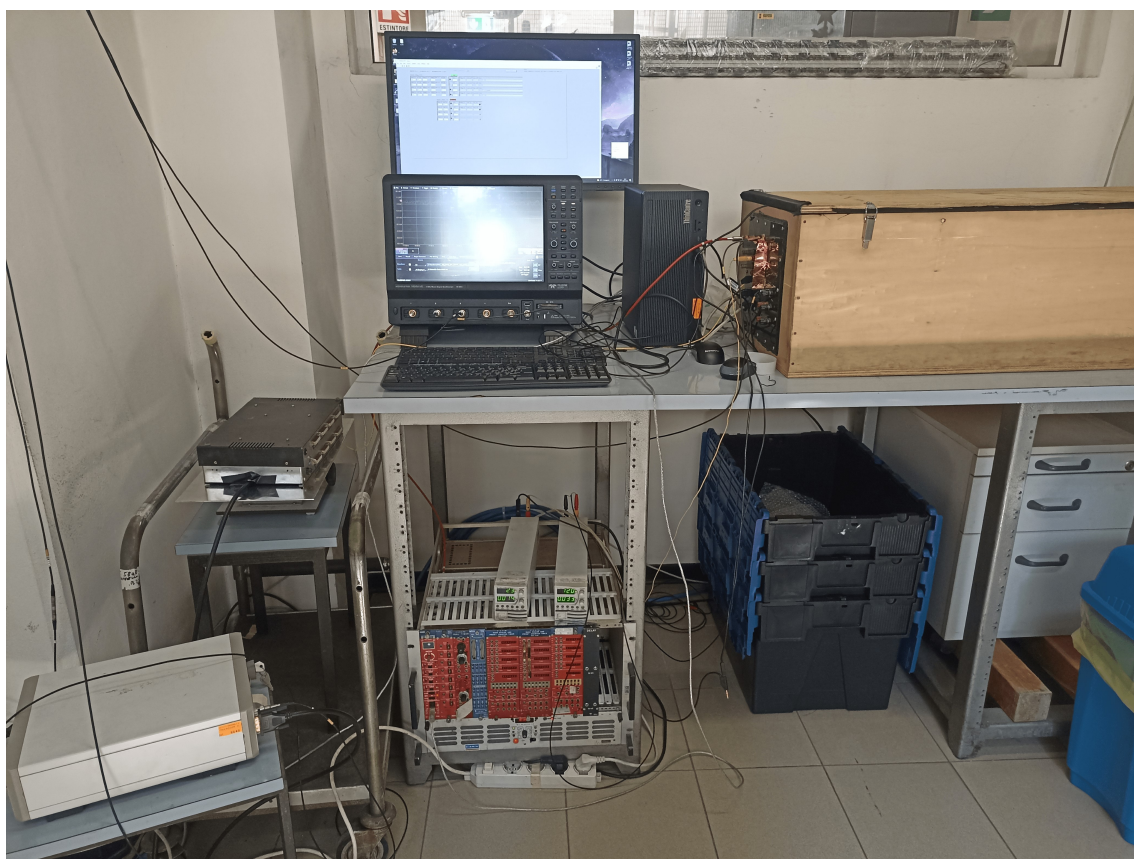
Figura 3.9: Setup della presa dati effettuata con il laser. A sinistra: il controller del laser e la testa laser. Al centro in alto: computer con il programma LabView e oscilloscopio. Al centro in basso: alimentatori di bassa e alta tensione. A destra scatola nera in cui è posizionato il sensore sotto test.
