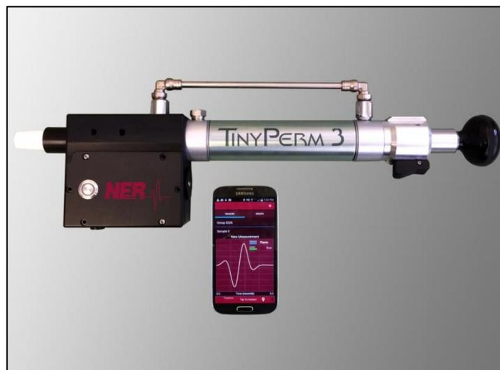
Figura 14: Modello di permeametro utilizzato: TinyPerm 3 prodotto dalla New England Research. Le misure si considerano affidabili nell'intervallo 1-10<sup>4</sup> milliDarcy.
