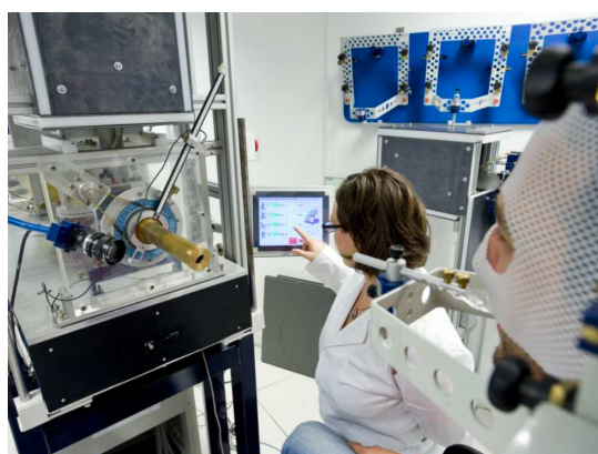
Fig. 1.2: fotografia scattata presso la sala di trattamento del centro di terapia protonica CATANA (LNS) tratte dall'archivio immagini ufficiale dell'Istituto Nazionale di Fisica Nucleare. Il paziente siede su una sedia realizzata in modo che ogni suo più piccolo movimento sia controllabile via
