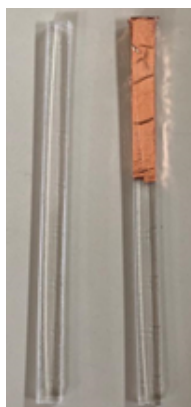
Figura 4.7: Bacchetta isolata (sinistra) e bacchetta conduttiva (destra)
