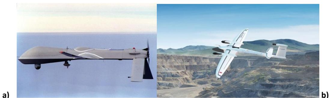
**Fig.1 a)** RQ-1A predator : drone con motore a 4 tempi, configurazione ala fissa, decollo e atterraggio orizzontale {6}. **b)** Trinity F90+ : drone con motore elettrico, configurazione ibrida, decollo e atterraggio verticale {7}.
