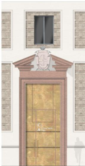
Dettaglio del portale di ingresso lungo Corso Canal Grande e del nuovo portone rivestito in ottone spazzolato. Il disegno complessivo vuole rievocare l'aspetto del muro nonché della finestra presente prima della realizzazione del portale a metà del 1800.
