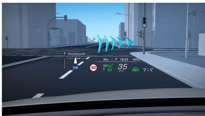
Figura 1.10: Dispositivo head-up display integrato in un'automobile [11]
