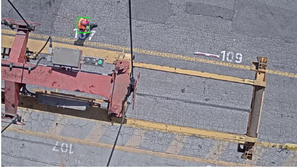
Figura 2.13: Zona circolare individuata nella ROI rettangolare della persona determinata in 2.11. Questa approssima discretamente la posizione della testa.
