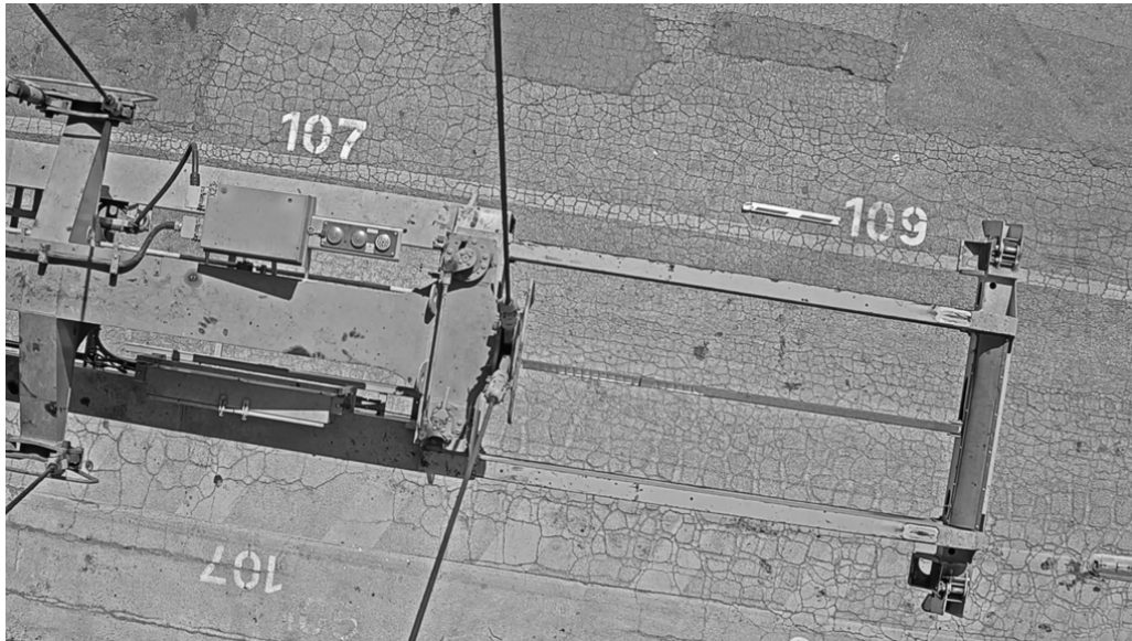
Figura 2.4: Modello dello sfondo in scala di grigi. Il valore di ogni pixel (x, y) dell'immagine è ottenuto calcolando la mediana del valore dello stesso pixel (x, y) in 50 frame casuali del video.
