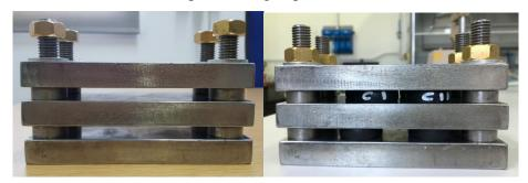
Figura 56. Distanziatore metallico vuoto (sx) e contenente i provini per compression set (dx).
