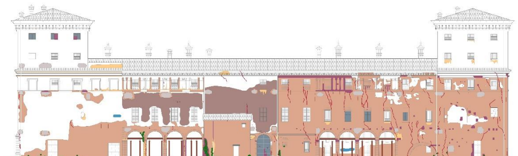
Fig. 61. Le forme di degrado sul prospetto lato fiume. (EdA)
