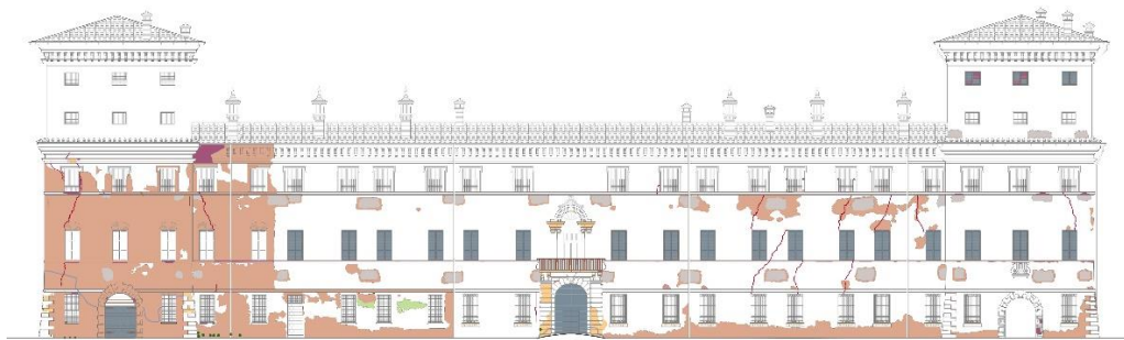
Fig. 60. Le forme di degrado sul prospetto principale. (EdA)
