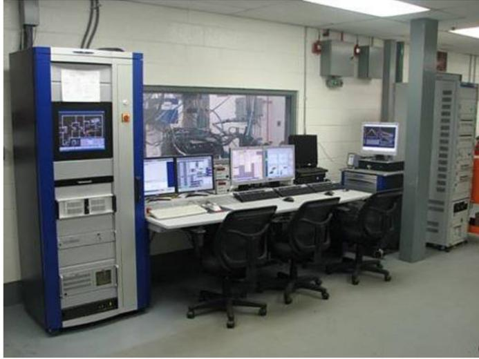
Figura 2.7: Sala comando di un banco prova motore
