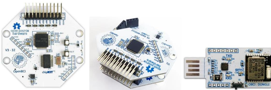
Fig. 2.25 Procedendo da sinistra si ha il modulo principale OpenBCI Cyton Board, il modulo aggiuntivo OpenBCI Daisy Module e la OpenBCI USB. [42]
