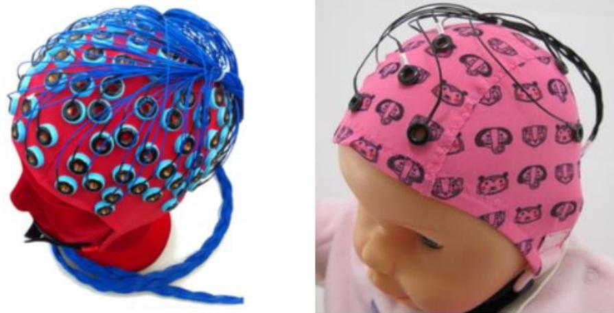
Fig. 1.15 Elettrodi premontati su cuffia. <sup>[9]</sup>
