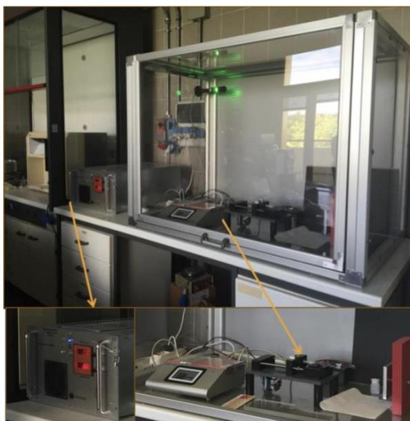
Figura 3.13 Strumentazione per elettrofilatura.
